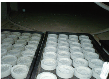
図1 薬剤処理後に住宅の床下に静置したモルタル皿
