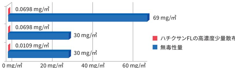
測定結果のうち最高検出濃度 (進入口0m) 及び進入口1.2mの検出濃度を、吸入毒性試験における無毒性量と比較しても、十分に低い濃度であった。
