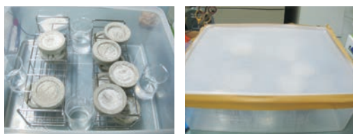
図3 中性化したモルタル皿に薬剤処理し、高湿度を保ったプラスチック容器内に密封し、30°Cのインキュベーターに保存
