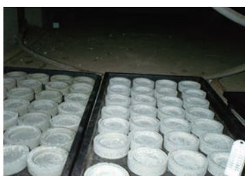
図1 薬剤処理後に住宅の床下に静置したモルタル皿
